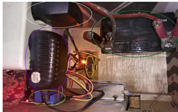
Gambar 6. Rangkaian keseluruhan Lingkaran merah adalah modul Bluetooth
